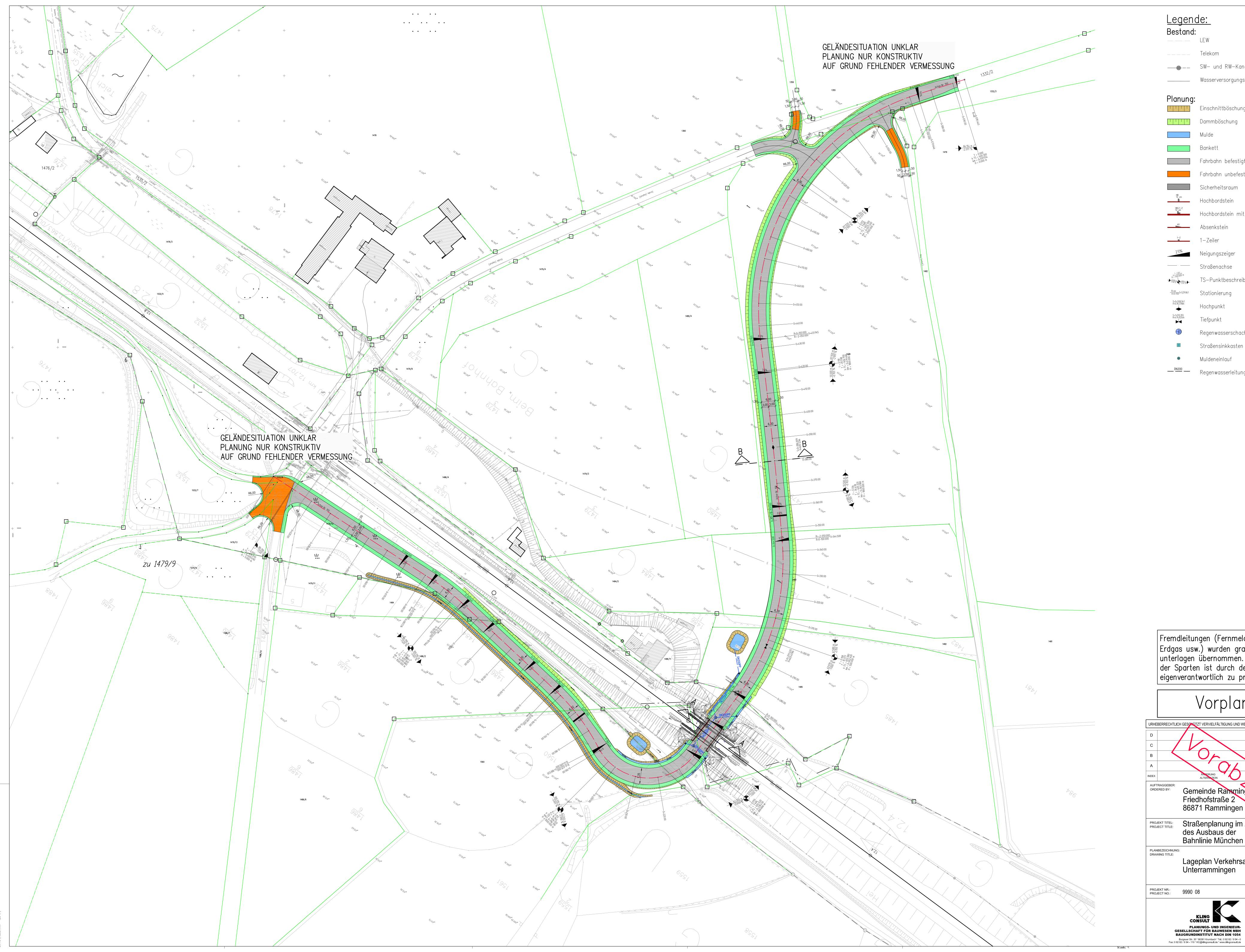
\_\_\_\_\_ Wasserversorgungsleitung Einschnittböschung Dammböschung Fahrbahn unbefestigt Sicherheitsraum Hochbordstein Hochbordstein mit 1-Zeiler Absenkstein ---- Straßenachse TS-Punktbeschreibung R=∞ A=0+100 0+529 861 Stationierung Regenwasserschacht Straßensinkkasten Muldeneinlauf
